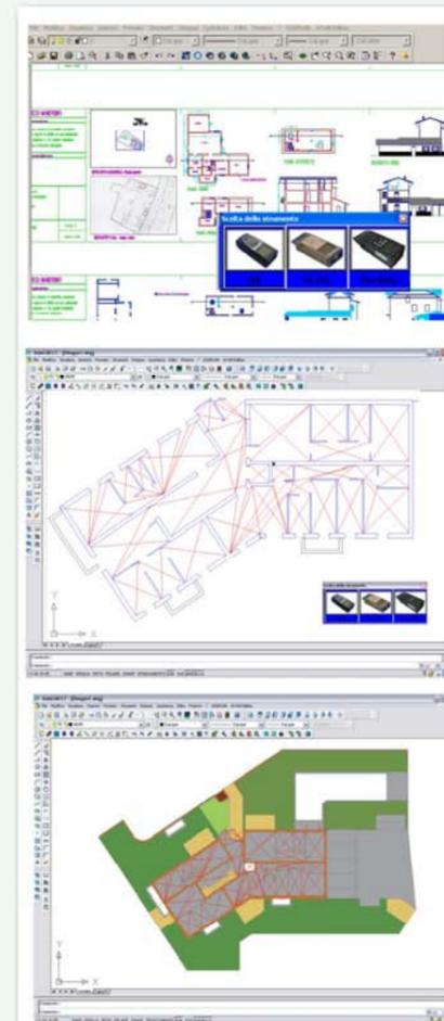
ArTeN Digiplan è stato creato per i professionisti che effettuano rilievi planimetrici architettonici sia con la corda metrica sia con strumenti digitali (stazioni totali, distanziometri laser ecc...) e si rende particolarmente utile nel rilievo planimetrico di edifici a pianta irregolare.
